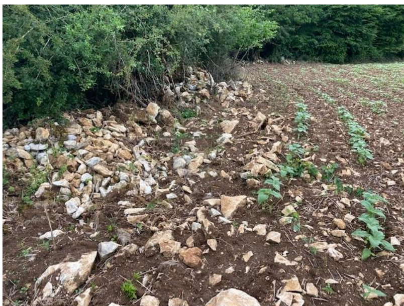
Figure 5 : Photographie illustrant la présence de la roche mère calcaire en surface (proche du sondage n°4)
